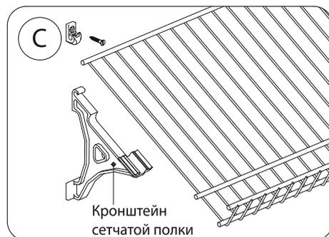
СХЕМА СБОРКИ СЕТЧАТОЙ ПРОДУКЦИИ «НАЙДИ»
